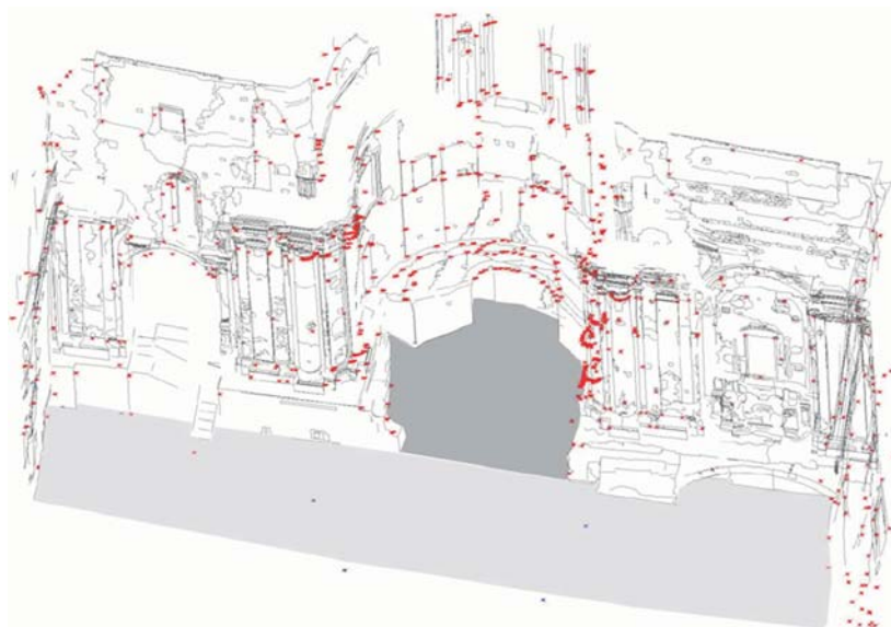
Figura 1 - Rilievo topografico di dettaglio e di appoggio fotogrammetrico e restituzione dei 17 modelli orientati
